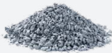
Die neueste Entwicklung ist AirClean®-Granulat, ein photokatalytisch aktives, künstliches Gesteinsgranulat, das als Abstreusplitt in die frische Asphaltdeckschicht von Straßen eingebaut werden kann.
