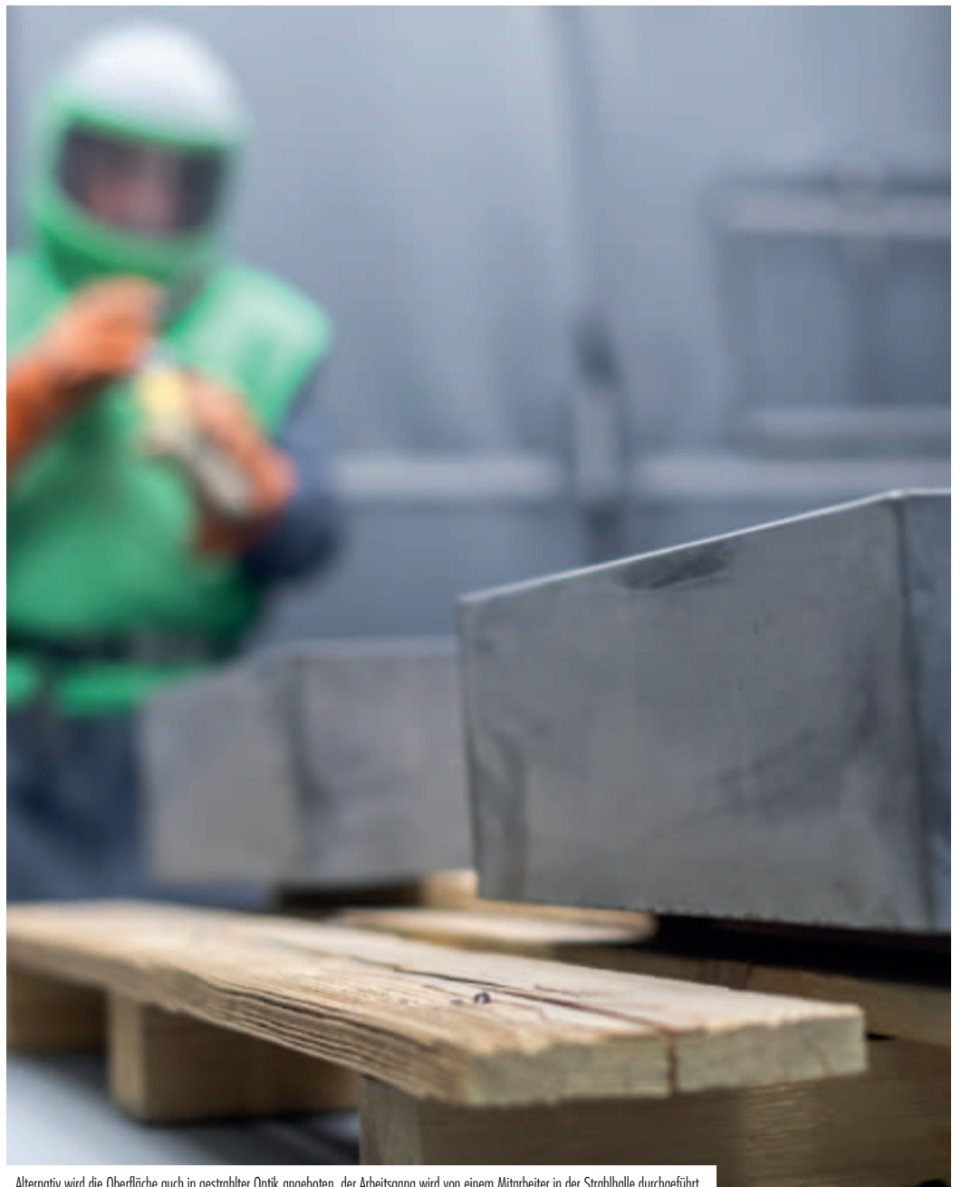
Alternativ wird die Oberfläche auch in gestrahlter Optik angeboten, der Arbeitsgang wird von einem Mitarbeiter in der Strahlhalle durchgeführt.
